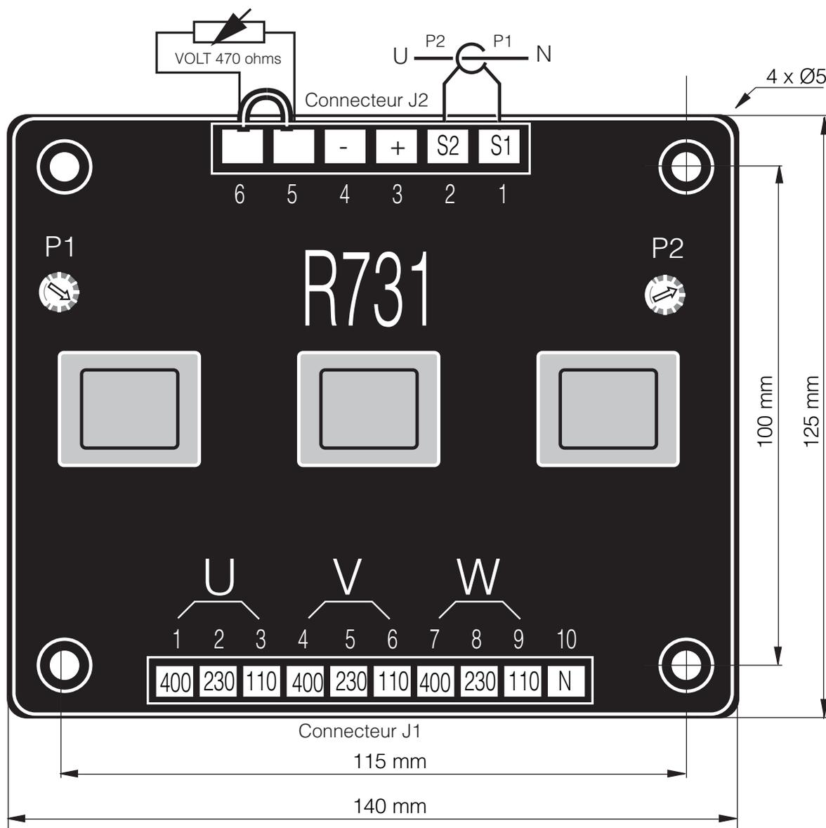
P1 : Potentiomètre tension / Voltage potentiometer
