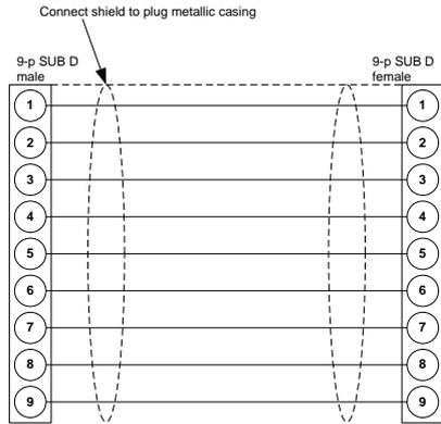
Wires min. 0.22 mm<sup>2</sup>, max. cable length 6 m.
